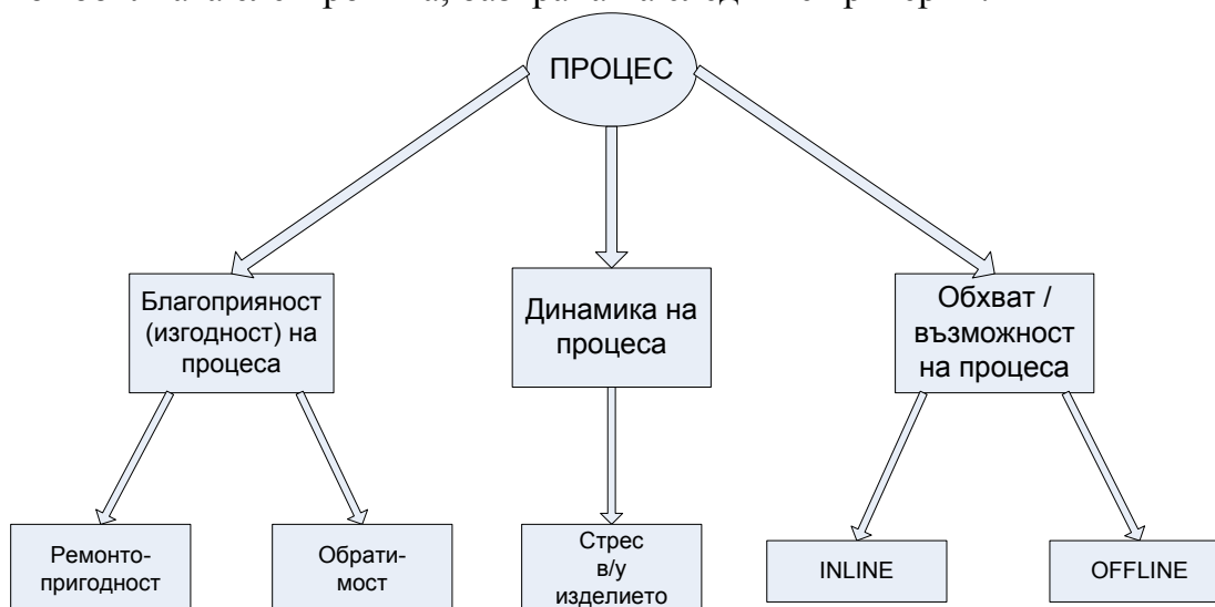
Фиг.5 Система за класификация на производствените процеси при асемблиране на управляващи модули в автомобилната електроника
