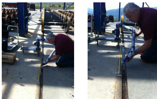
Фиг. 3-1 Измерване на вълнообразност на релсите със система FARO при това изследване
