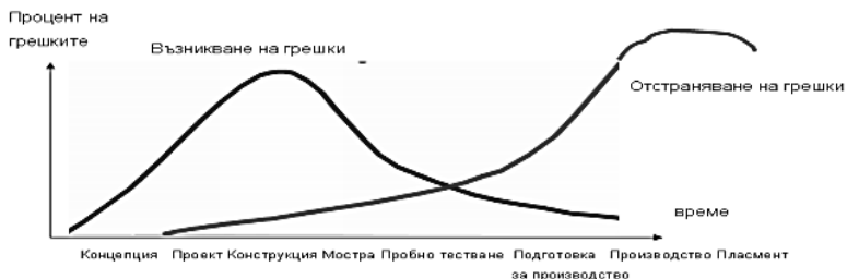
Фиг. 2.2. Възникване и отстраняване на грешките в етапите на развитие на продукта
