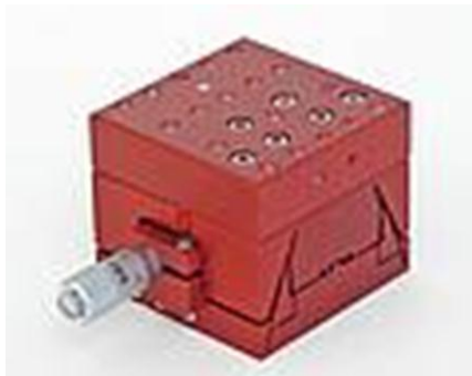
Фиг. 8. Гониометричен модул с еластични направляващи
