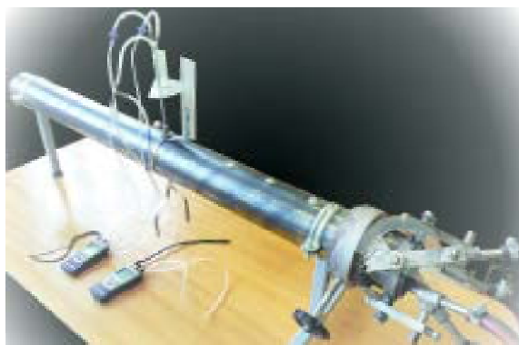
Фиг.3. Лабораторен стенд за изследване аеродинамиката на инжектирана, ограничена, завъртяна струя, при изотермични условия.
