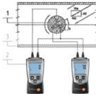
Фиг.4. Схема на измерване големината и посоката на действителната скорост. 1-цилиндрична триканална сонда; 2-диференциални манометри; 3-цилиндричен канал.
