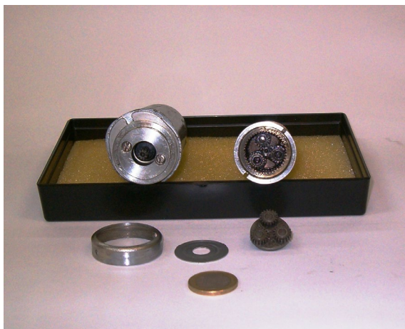
фиг.8 Кинематична схема и общ вид на предавката в електромеханична отвертка на ЗППУ-Габрово произведена по метода на нишковата ерозия
