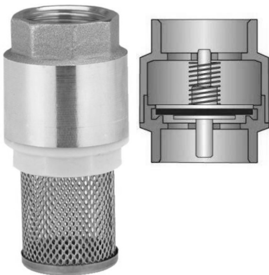
фиг. 3 Смукателен клапан
