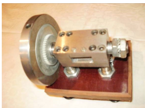
Фиг.6 Блокиращ контур и практическа реализация на еволвентна цилиндрична зъбна предавка с асиметричен профил и равен брой зъби на колелата z_2=z_1=44 , профилни ъгли на инструмента \alpha=20^\circ и \alpha^*=30^\circ , произведена по метода на електроенергийна обемна ерозия
