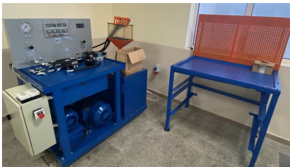
Фиг.3.Реално изграден стенд за изпитване на ХП.
