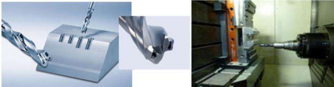
фиг. 4 Свредловане на наклонени повърхнини на ролкови танкети
