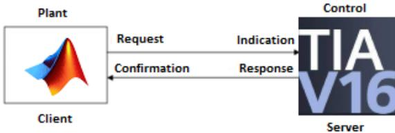
Fig. 22. MODBUS Client/Server
