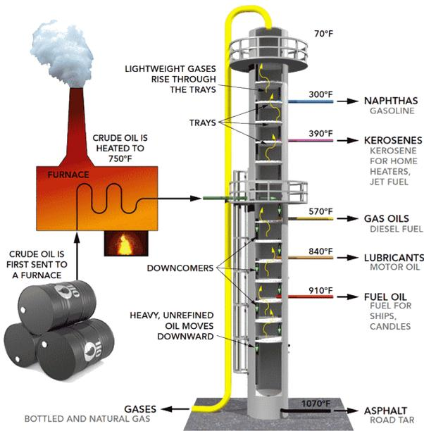
Fig. 1. Rectification column
