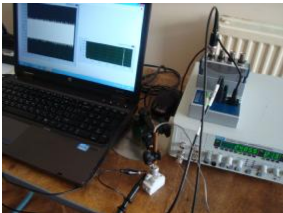
Фиг. 5. Фотография на стенда за изследване на ултразвуковия генератор на енергия: 1. Ултразвуков генератор; 2. Стойка с излъчвател на ултразвук; 3. Генератор на напрежение; 4. Система за събиране на данни; 5. Лаптоп.
