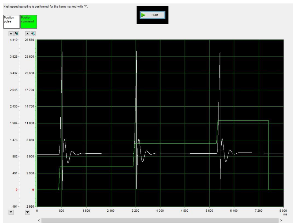
Фиг. 10. Експериментални резултати на заданието за позиция и грешката от зададената и отработената позиция
