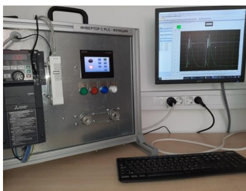
Фиг. 7. Инвертор с вградено PLC управление Mitsubishi A800
